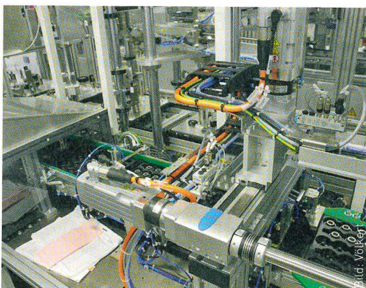
Zuführung der Dichtung der Wasserpumpe in Blistern, Vereinzlung über ein X-Y-Fächensportal mit Z-Hub-Greifer, Maschine während der Inbetriebnahme bei MP.
