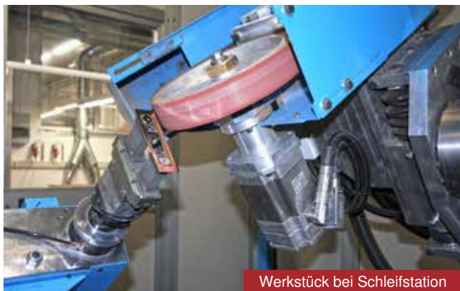
4 Werkstückaufnahmen mit je 2 Achsen, 1 Schleifeinheit mit 2 Schleifstationen, 2 Doppelpolierereinheiten mit je 2 Polierstationen. Alle Stationen 5-achsig
